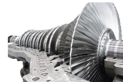
蒸気タービン
