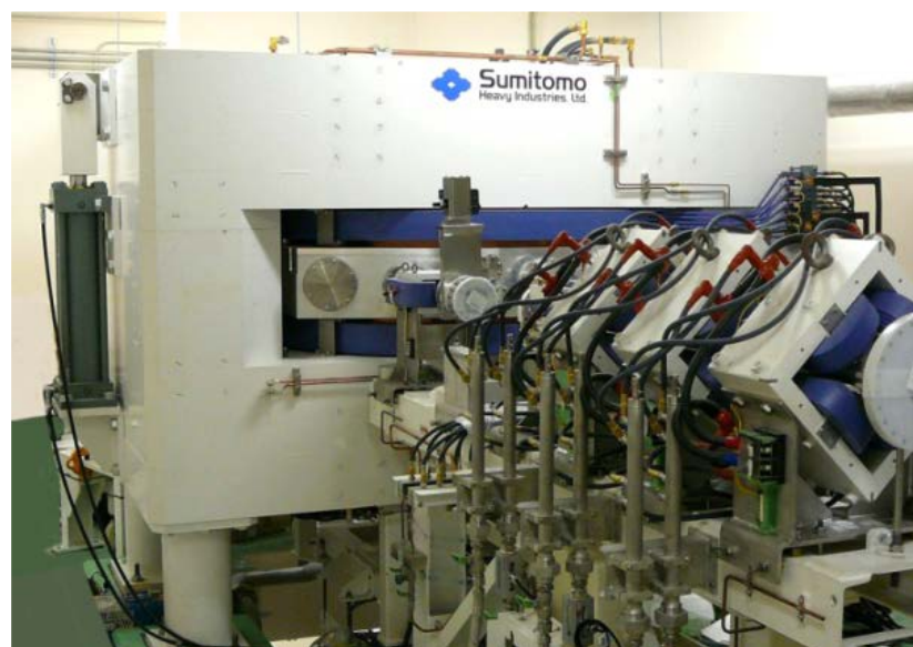
加速器を用いた BNCT システムおよび BNCT 用サイクロトロン
