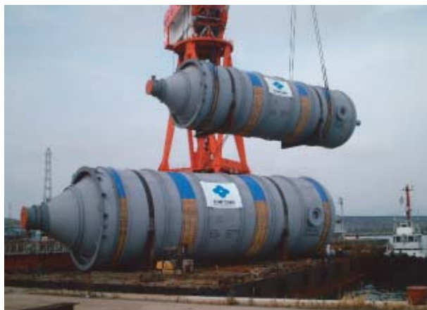
石油精製用コークドラム
