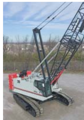
110トン クローラクレーン LS-218HSL
