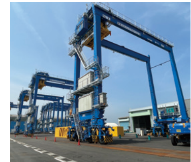
遠隔操作RTG
