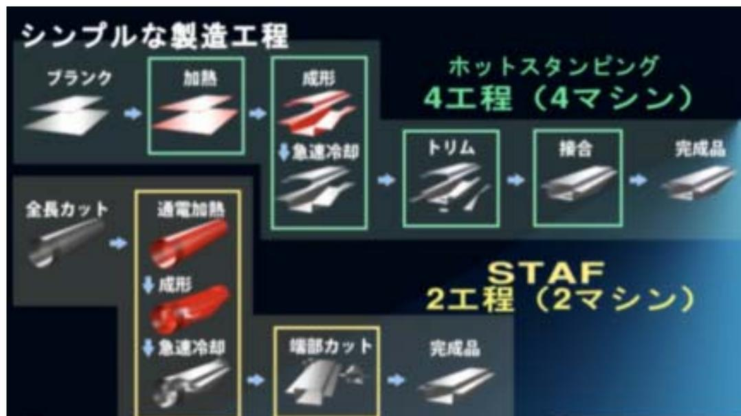
従来工法(ホットスタンピング)と比較した製造工程イメージ。
