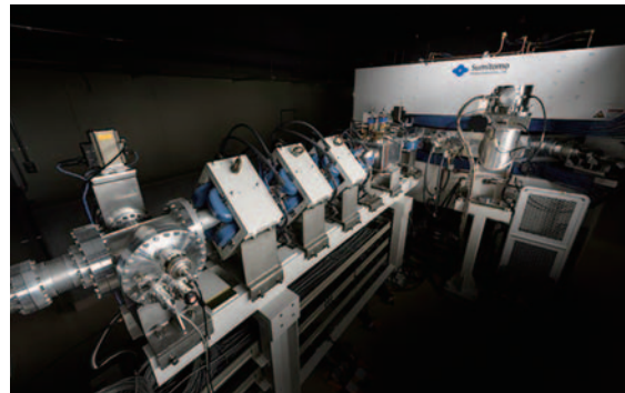
小型中性子発生装置 (脳神経疾患研究所附属南東北BNCT研究センター納入)
