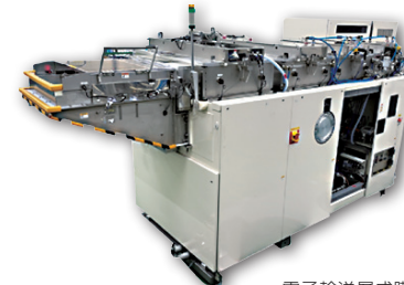
電子輸送層成膜技術確立した真空成膜装置
