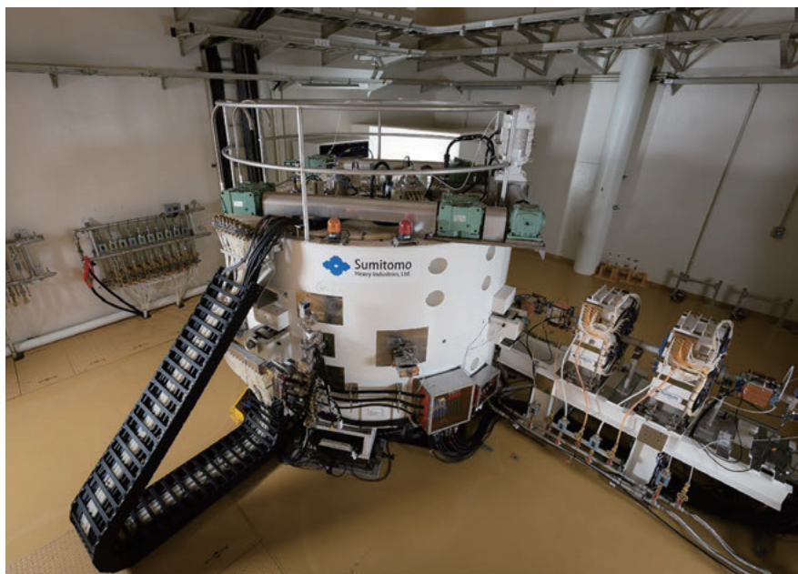
陽子線がん治療向け超電導 AVF サイクロトロン SC230 Superconducting AVF cyclotron for proton therapy SC230
