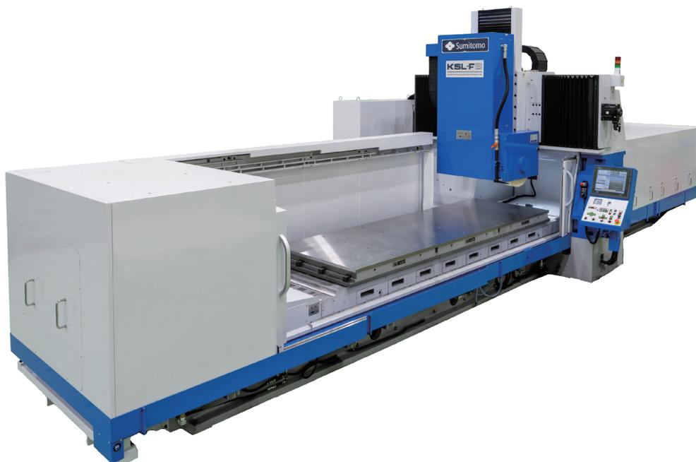
KSL-F 8 シリーズは、自動車用モータコア金型やプレス金型、プラスチック金型をターゲットに開発された、テーブル作業面幅800mmの門形平面研削盤である。昨今の働き方改革の推進や生産労働人口の減少による労働力不足、熟練作業者の引退による技能伝承問題に対して、操作性や作業性の面から高い評価を受けている。
